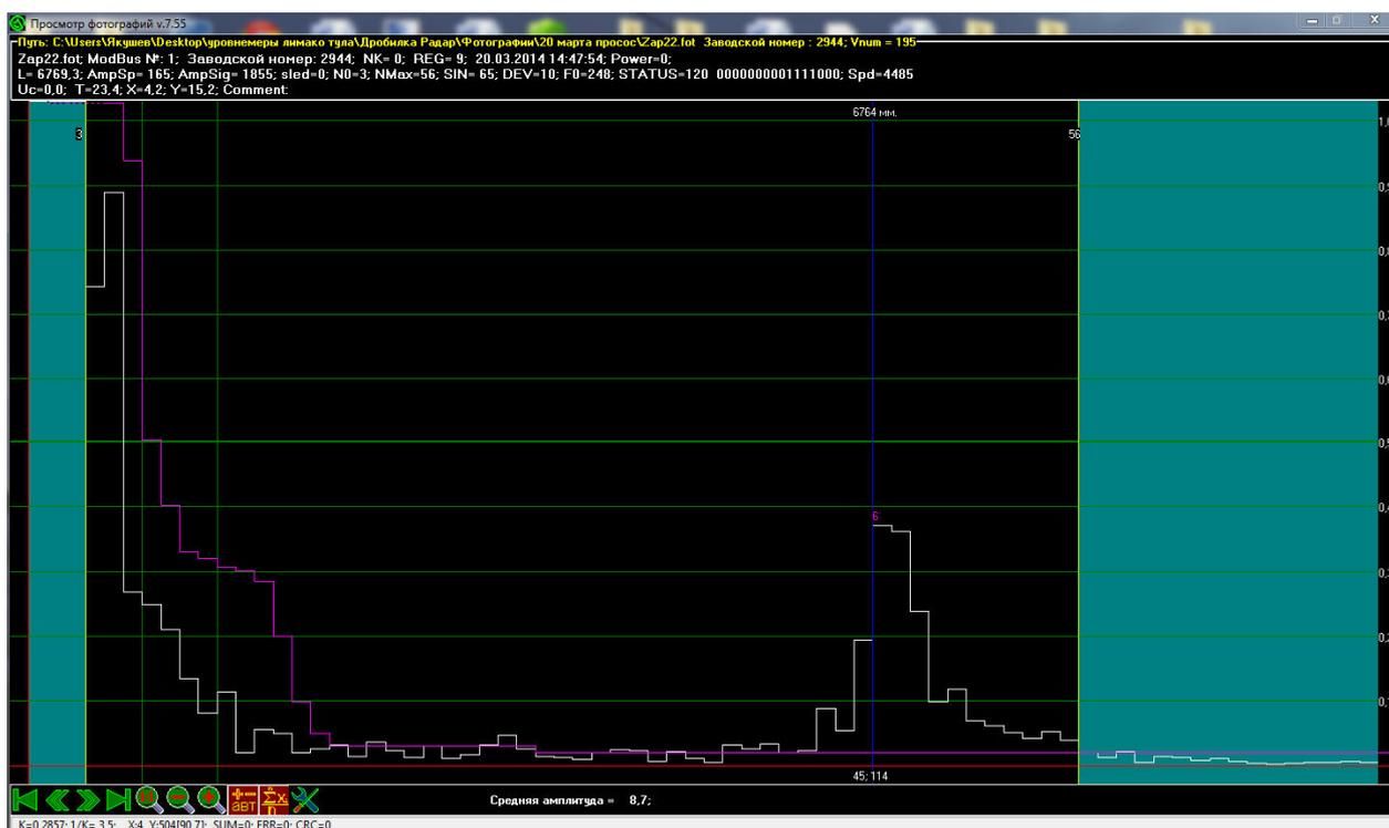
Фото 5. Осциллограмма спектра переданного и отраженного сигналов уровнемера УЛМ31А1
