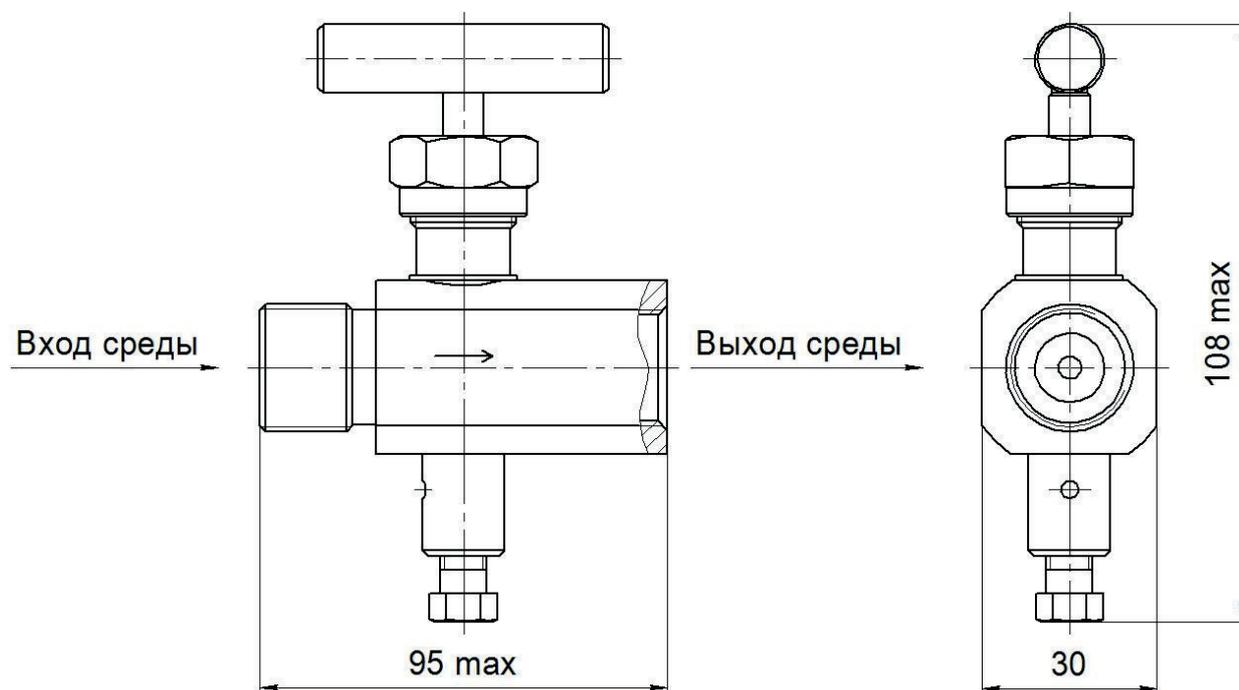
**Рисунок Г.1 – Клапанный блок БКН1**
