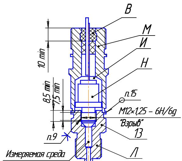
Рис. Д.4 – Для исполнения датчиков избыточного давления с верхним пределом измерения более 600 кПа.
