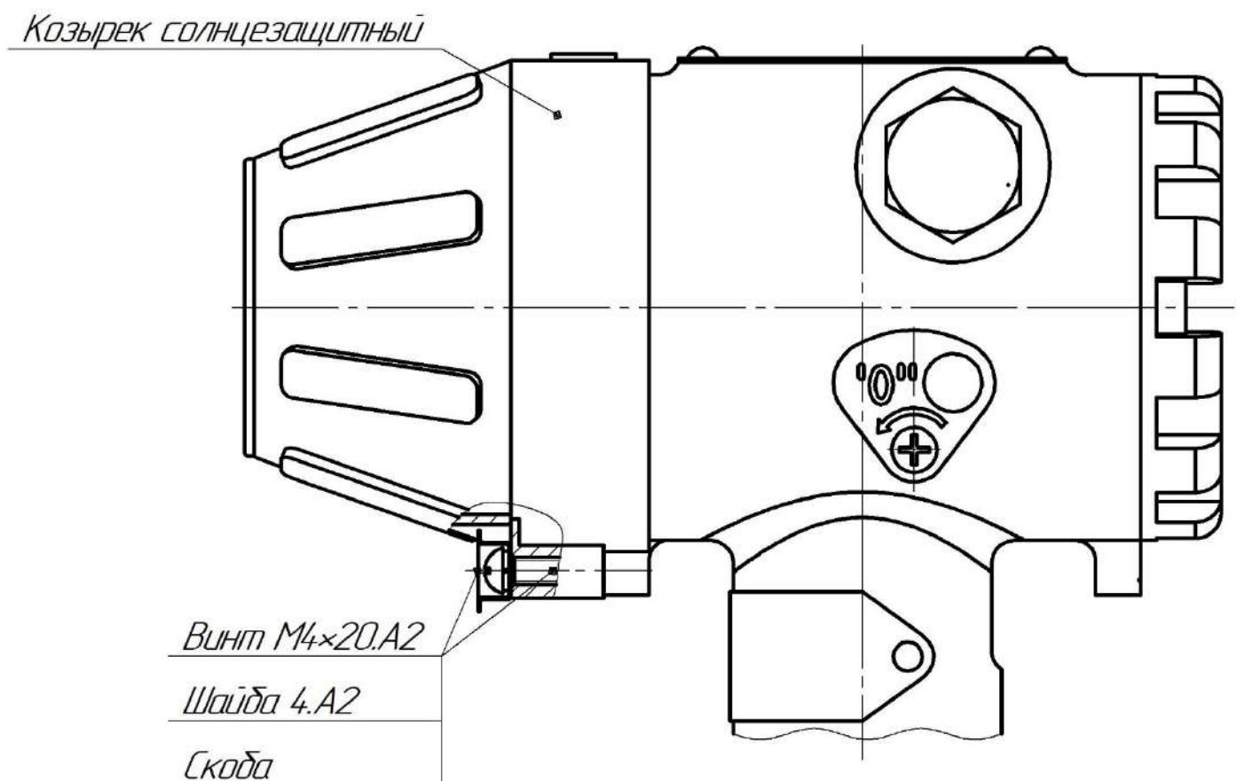
*Рисунок Г.10 – Солнцезащитный козырек «ЦИК» для датчиков
