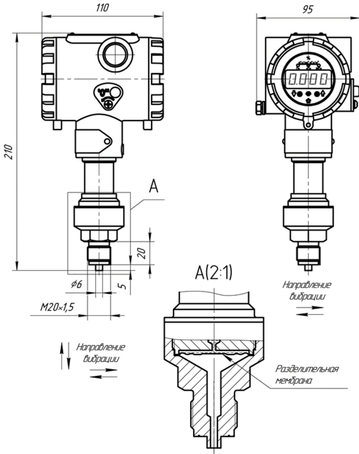
Конструкция моделей с разделительной мембраной, неразборная.
