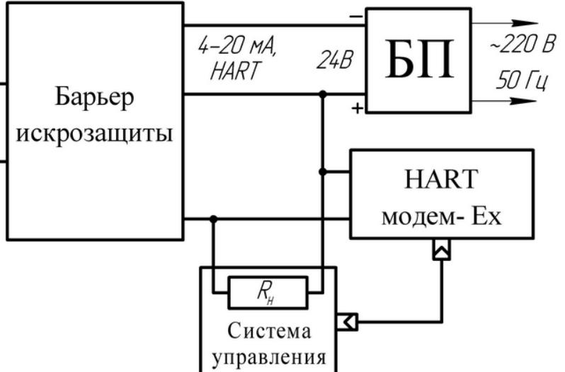
Рисунок Б.6 - Схема соединения для датчиков Агат-100МТ-Exi
