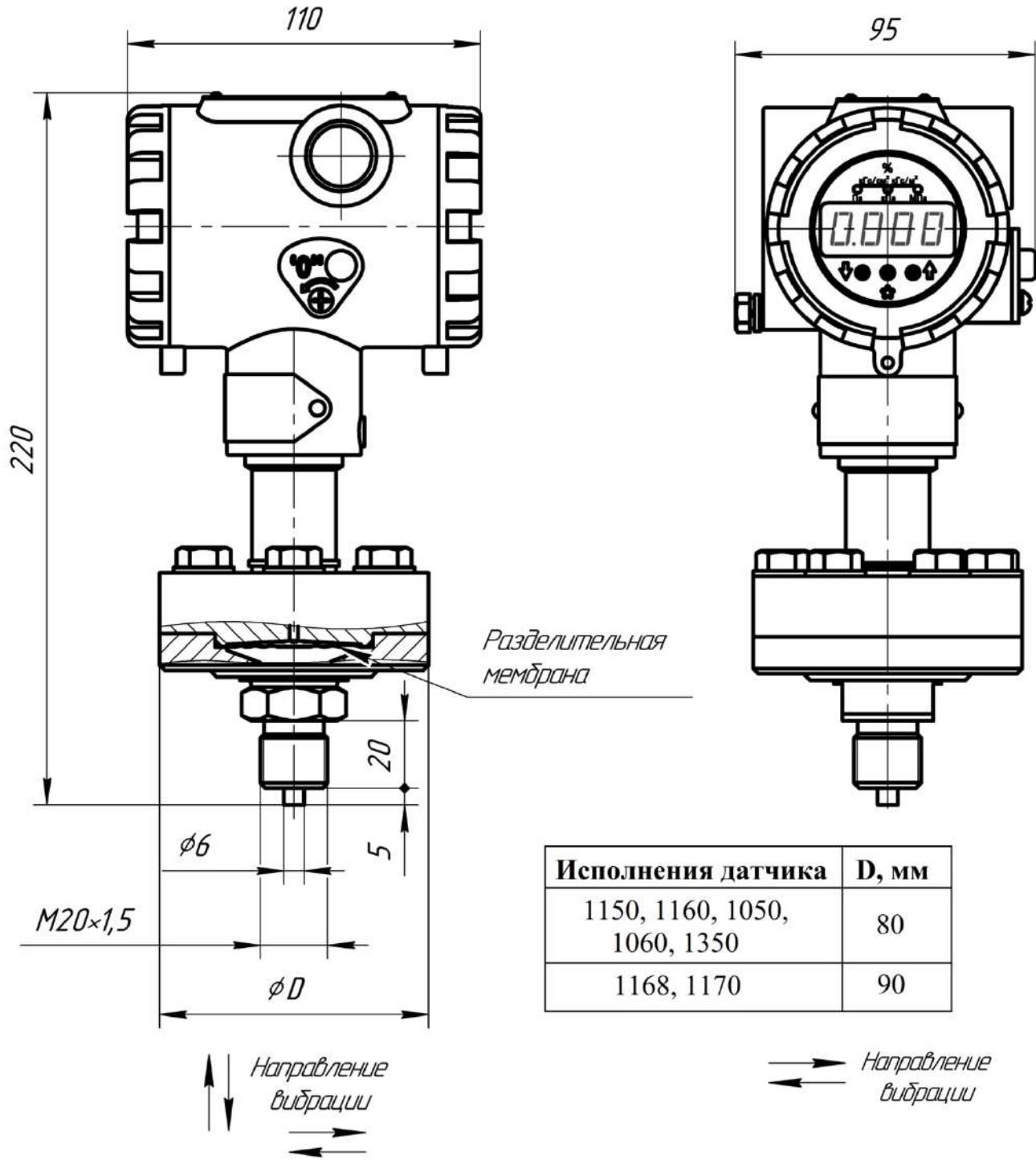
Конструкция датчика с разделительной мембраной, разборная.
