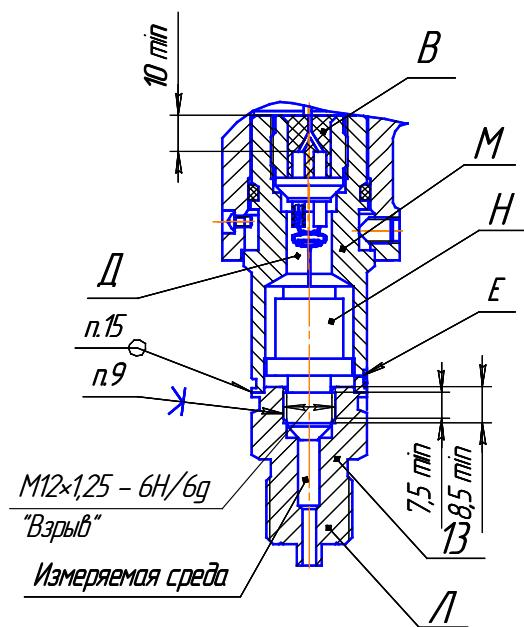
Рис. Д.3 – Для исполнения датчиков абсолютного давления с верхним пределом измерения более 600 кПа.
