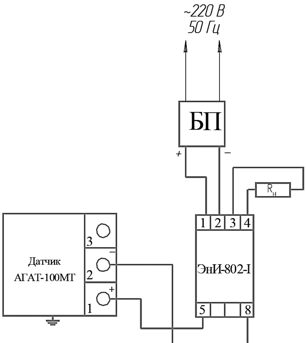
Рисунок Б.7 – Схема соединения датчика Агат-100МТ
