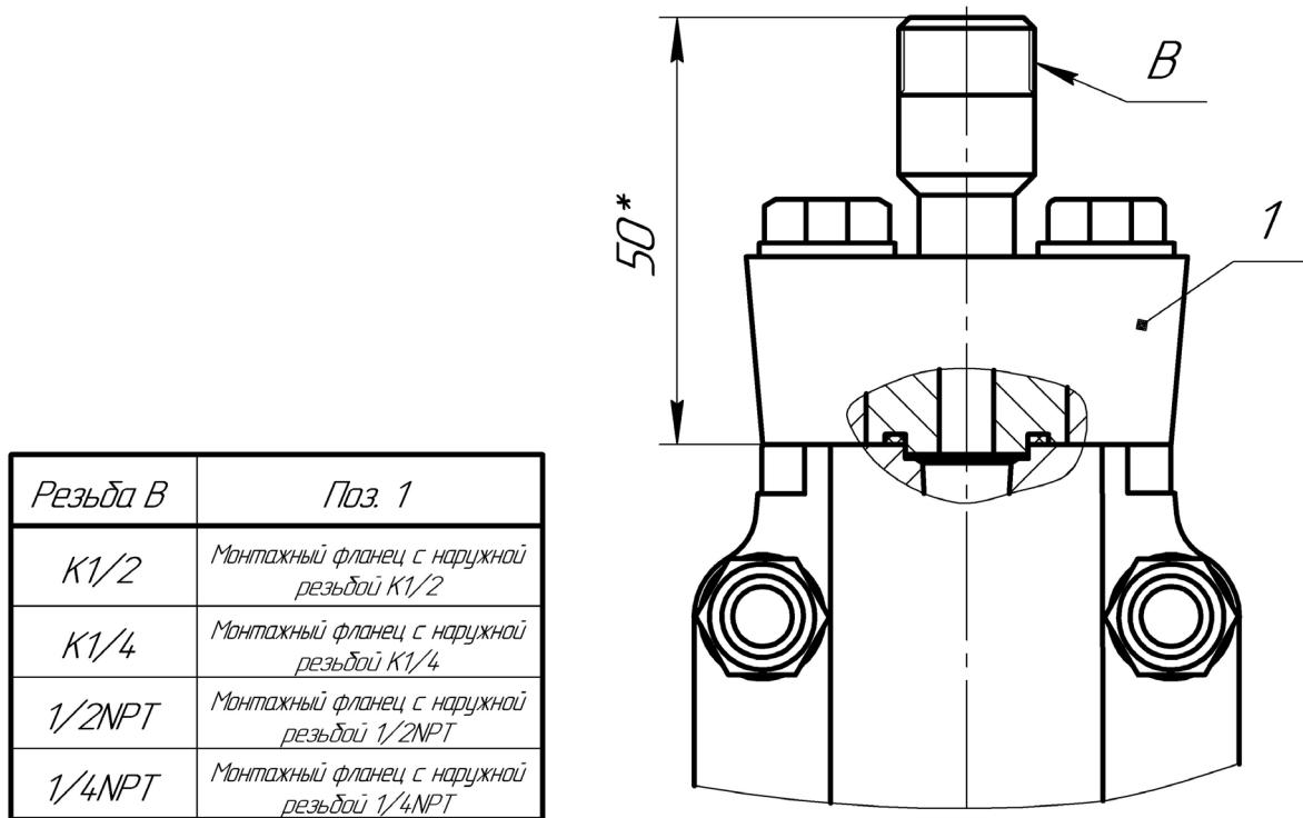
Рисунок Г.3 – Комплект монтажных частей « $K1/2_{\text{нар}}$ », « $K1/4_{\text{нар}}$ », « $1/2NPT_{\text{нар}}$ », « $1/4NPT_{\text{нар}}$ » для исполнений датчиков по рис. А.1, А.2, остальное см. рис. Г.1
