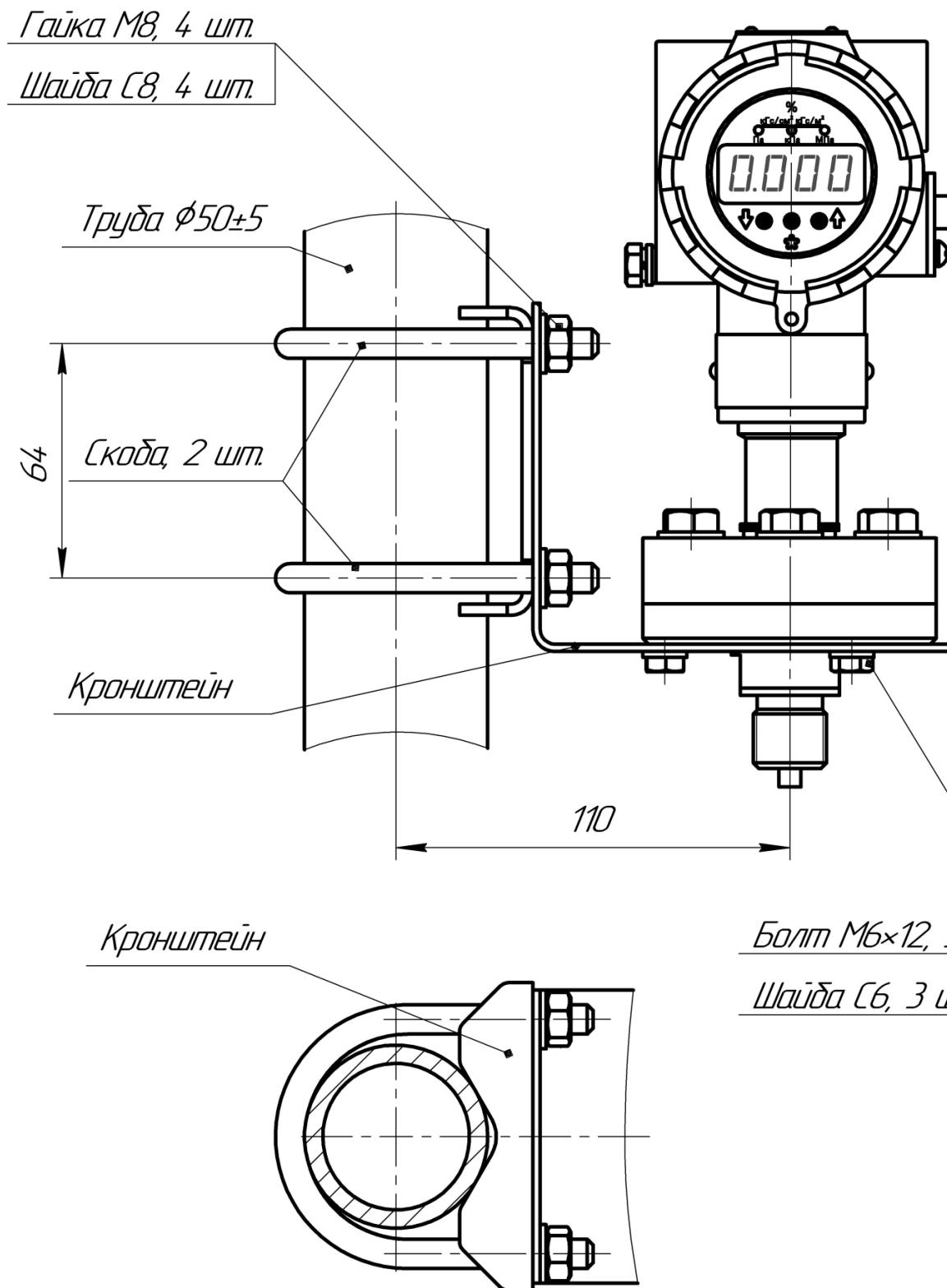
Рисунок Г.7 – Монтажный кронштейн «СК» для исполнений датчиков давления по рис. А.5
