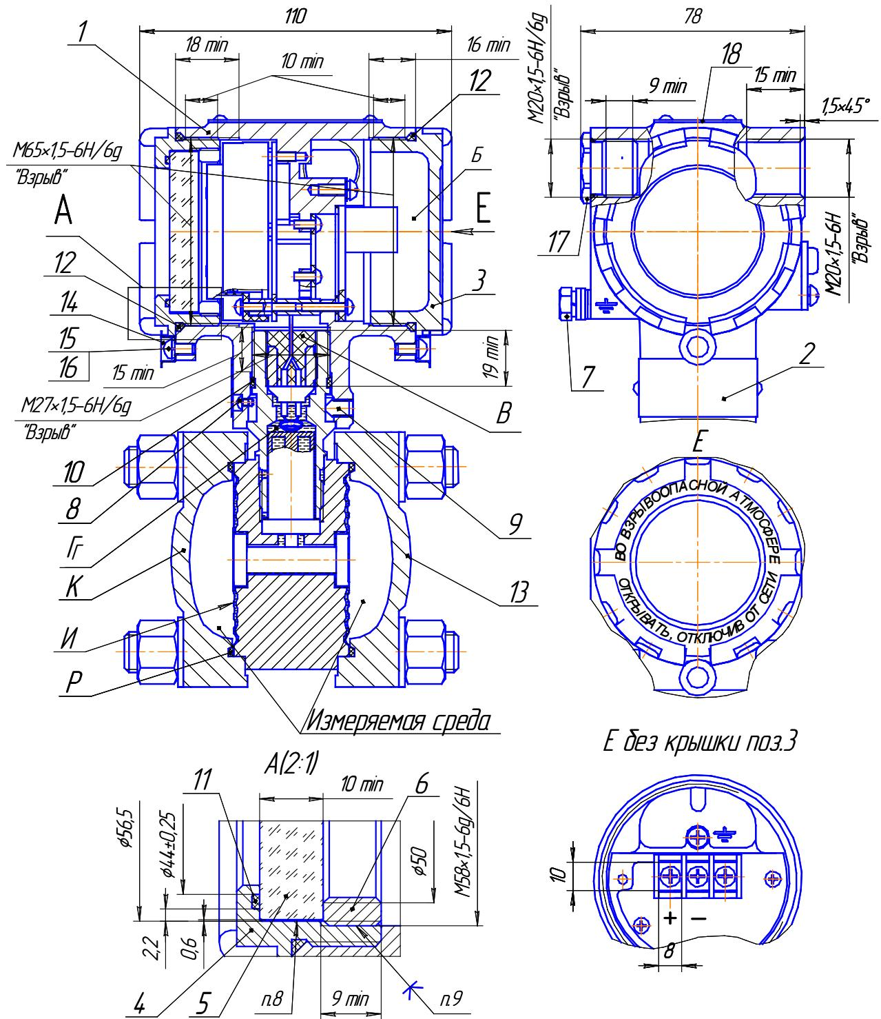
Рисунок Д.1 - Для исполнения датчиков со встроенным
