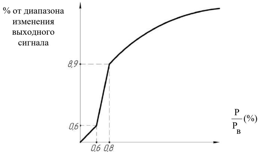
Рисунок 1 – Функция преобразования давления по закону квадратного корня датчиков давления
