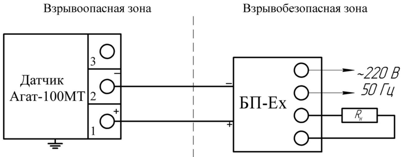
БП-Ex - искробезопасный блок питания по 1.2.14
