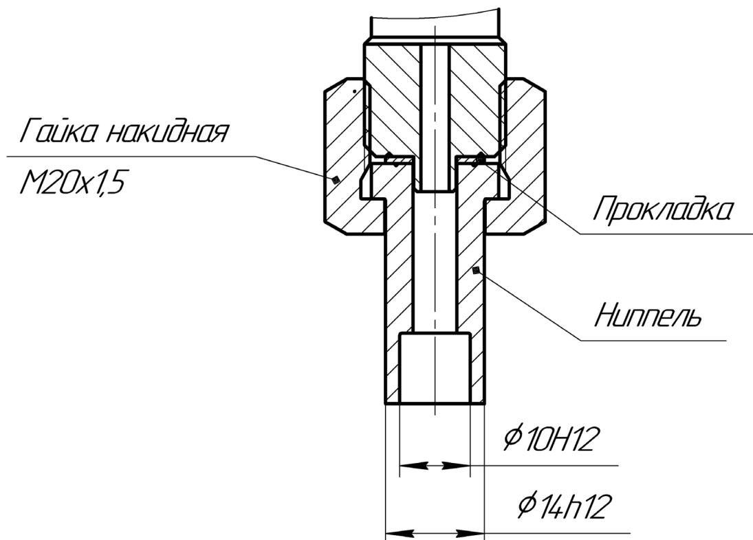
Рисунок Г.4 – Комплект монтажных частей «M20» для исполнений датчиков давления по рис. А.4, А.5, А.6
