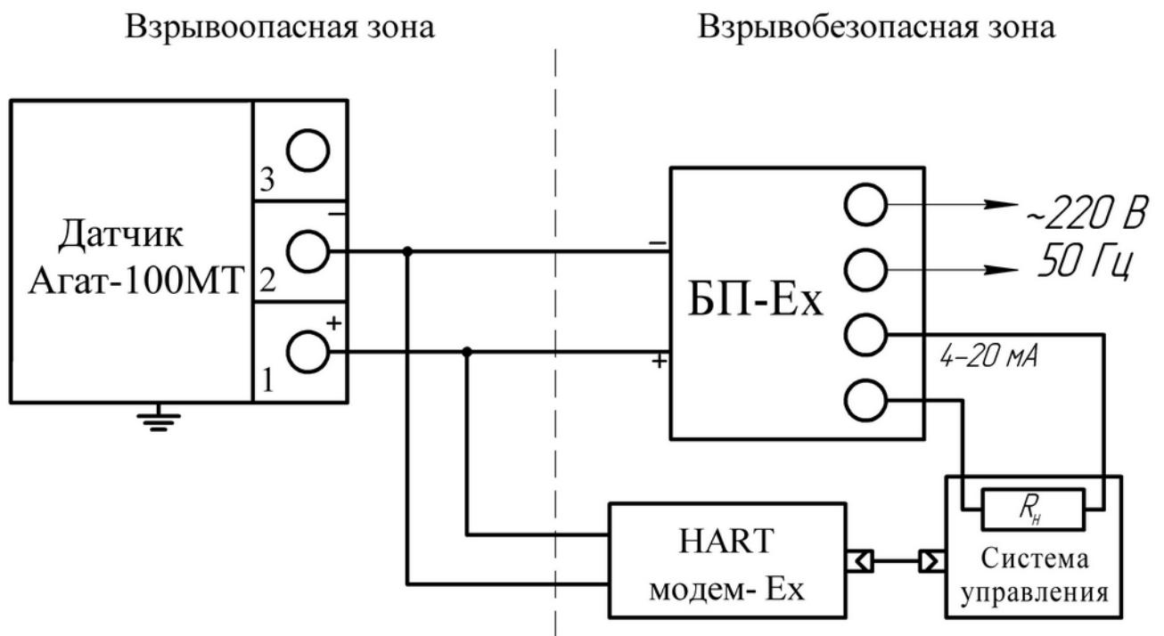
Рисунок Б.4 – Схема соединения для датчика Агат-100МТ-Exi
